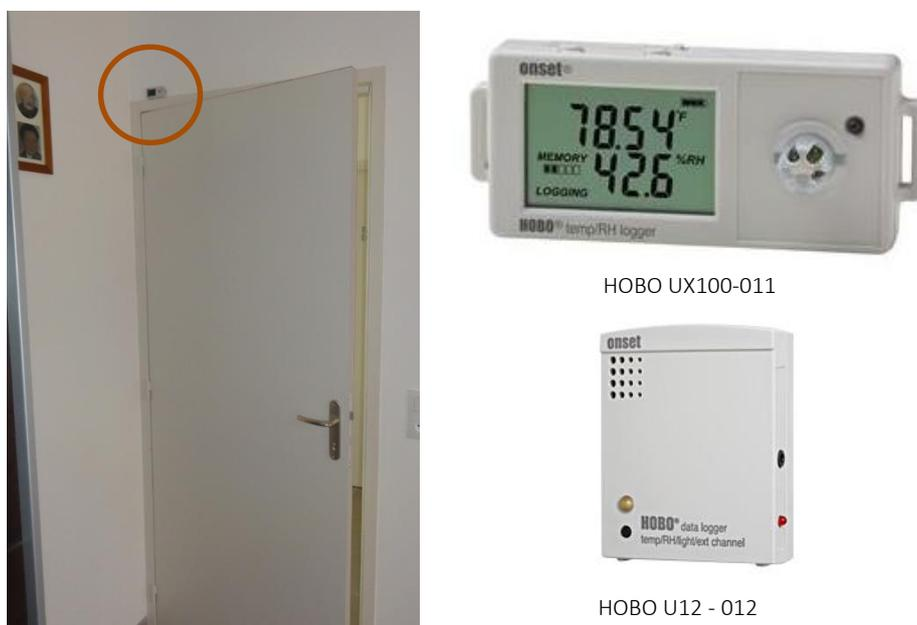
Figure 2: Installation des capteurs HOBO dans des zones protégées
