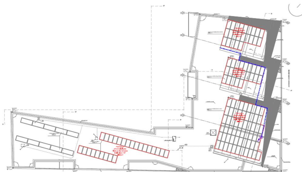
Figure 4: Plan d'installation des panneaux photovoltaïques sur la toiture.
