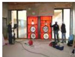
La mise en pression d'un volume est rendue possible par l'utilisation d'une porte soufflante (cf. photo ci-dessus à droite).
