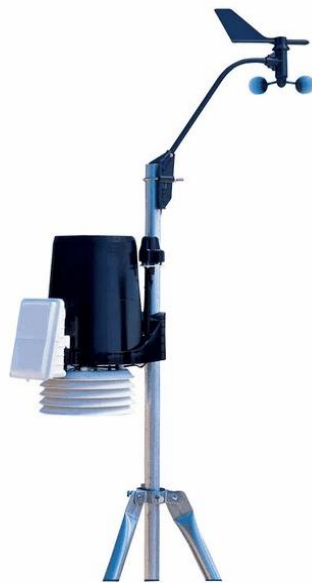
Figure 1: Station météo Vantage Pro 2
