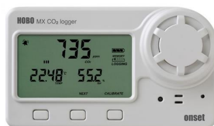
Figure 4: Capteur de concentration en CO2 HOBO MX1102 (dimensions 7.62 x 12.95 x 4.78 cm)
