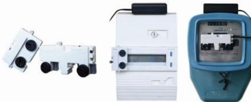
Figure 6 : Enregistreurs d'index de consommation électrique Fludia BelSenso FM300
