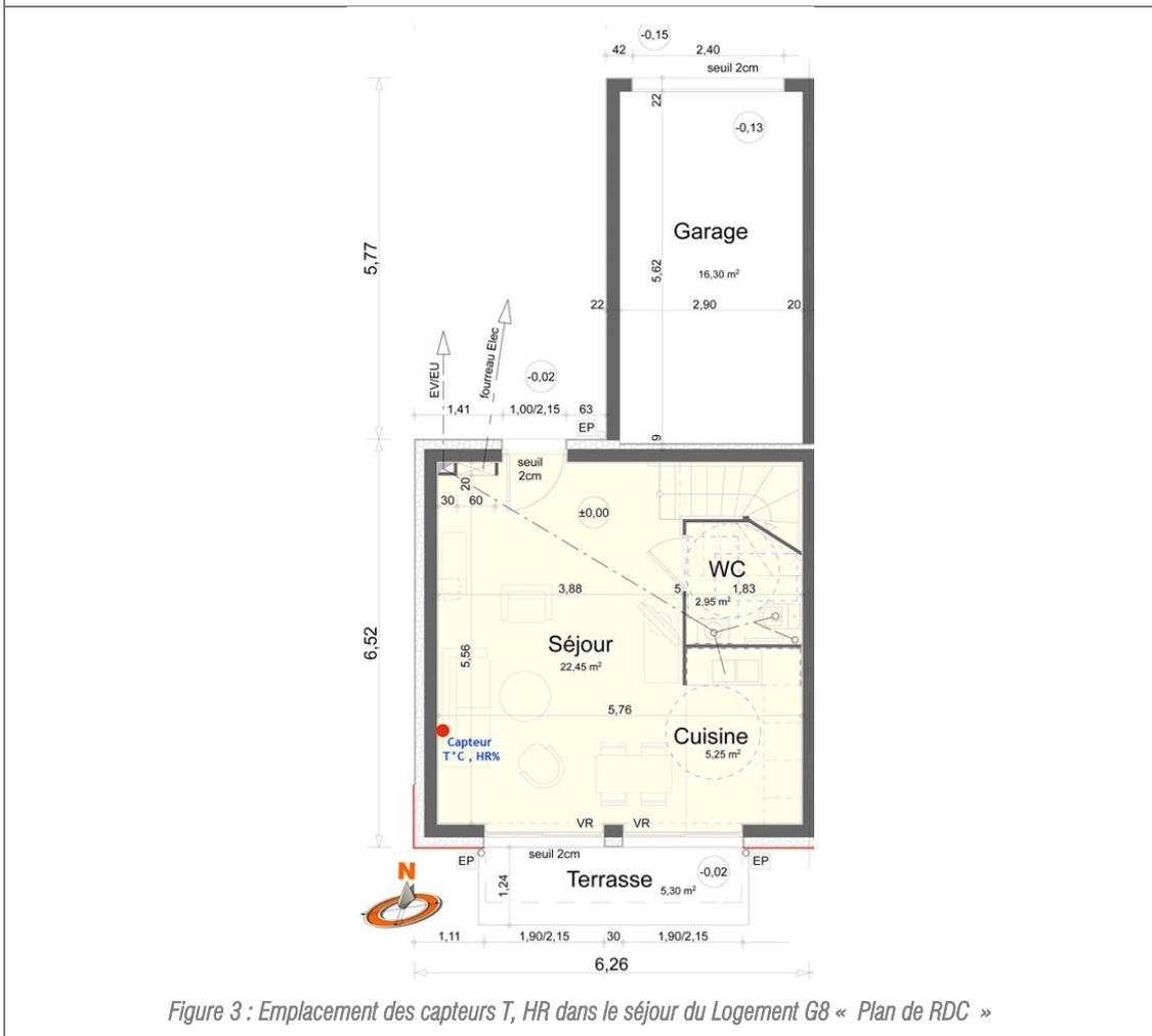
Figure 3 : Emplacement des capteurs T, HR dans le séjour du Logement G8 « Plan de RDC »
