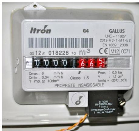
Figure 9 : Instrumentation d'un compteur de gaz avec un émetteur d'impulsions Itron G4 Gallus
