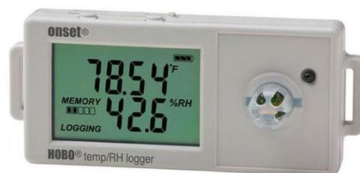
Figure 3: Capteur de température et hygrométrie HOBO-UX100-011 (dimensions : 3.66 x 8.48 x 2.29 cm)
